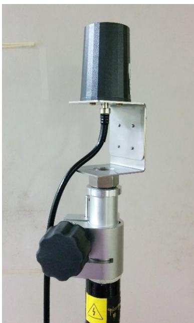
図: アンテナ取り付け器具へのアンテナ設置(5)
